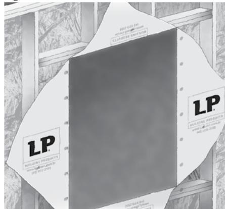
17. Após a instalação da membrana recomenda-se vedar todas as aberturas de esquadrias com a uma fita adesiva asfáltica impermeável. Esta fita deve ser aplicada na abertura de maneira uniforme, como uma peça única em todo o contorno da abertura, evitando emendas e recorte, para garantir a estanqueidade total da abertura. Inicie a aplicação da fita por um dos vértices superiores da abertura, no caso de janelas, ou pelo rodapé inferior no caso de portas. - Figura 4.
